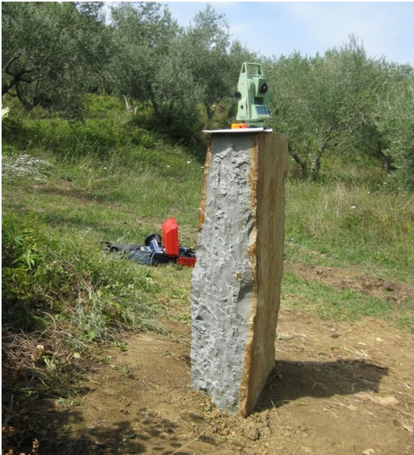
Slika 3: Določanje značilnih parametrov na merilnem kamnu za absolutne meritve. Predhodne meritve za geomagnetni observatorij PIA (Piran, Slovenija), ki so bile dokončane v letu 2019.
