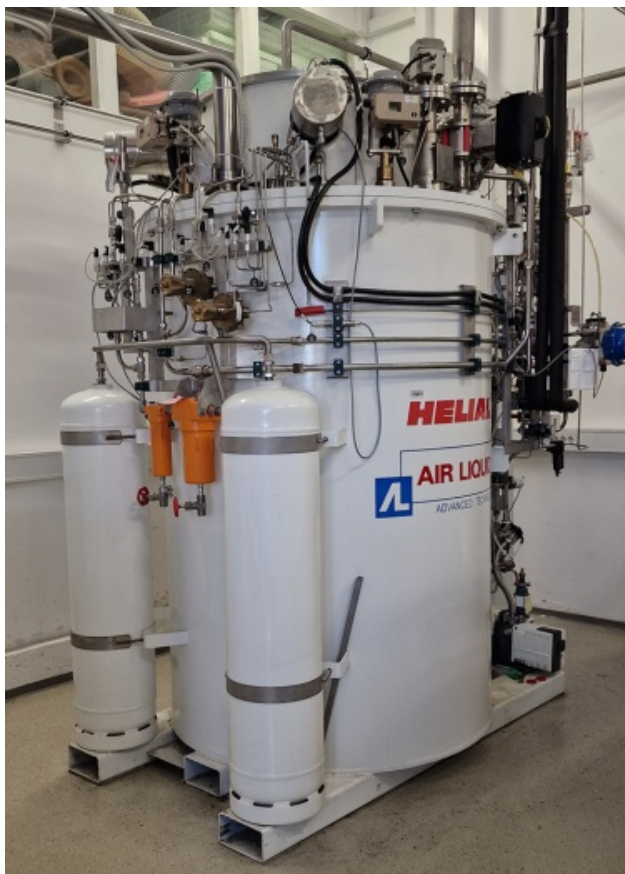
Slika 3: Levo cold box , osrednji del utekočinjevalnika; desno Dewarjeva posoda, zalogovnik utekočinjenega helija. Foto: Jože Luzar, Institut "Jožef Stefan"
